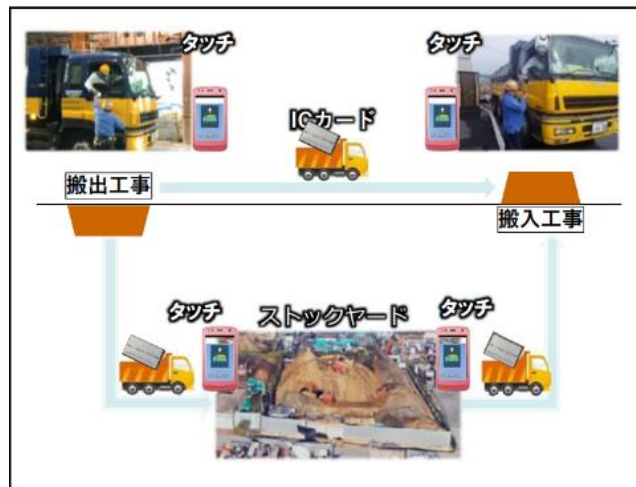
図 2-(2)-イ-14 建設発生土トレーサビリティシステム概念図
