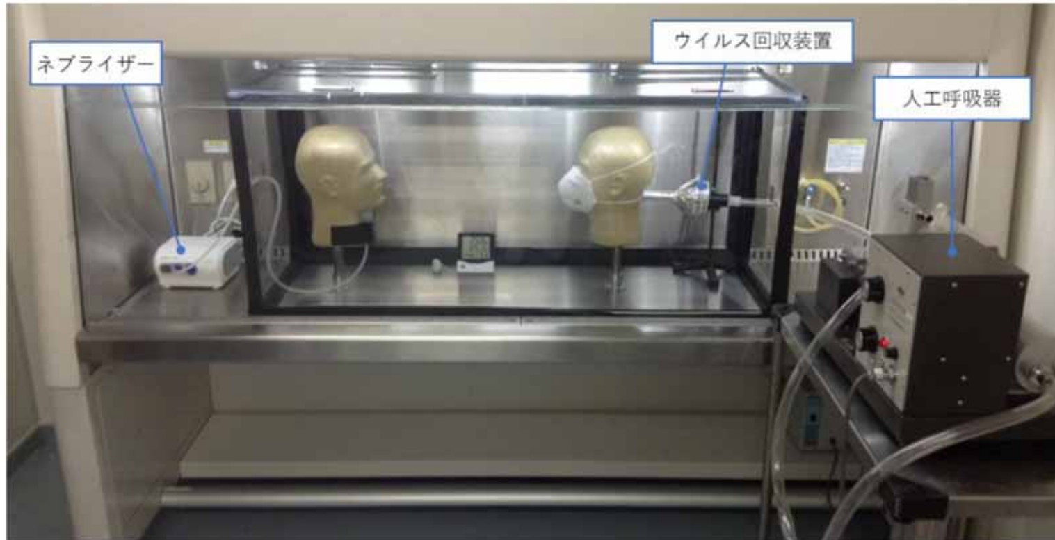
図1 BSL3 施設内に設置したウイルス噴霧チャンバー 左側のマネキンの口から SARS-CoV-2 が噴出されチャンバー内に拡散する。右側のマネキンには人工呼吸器が繋がれており、吸い込んだウイルス粒子はウイルス回収装置に捕集される。
